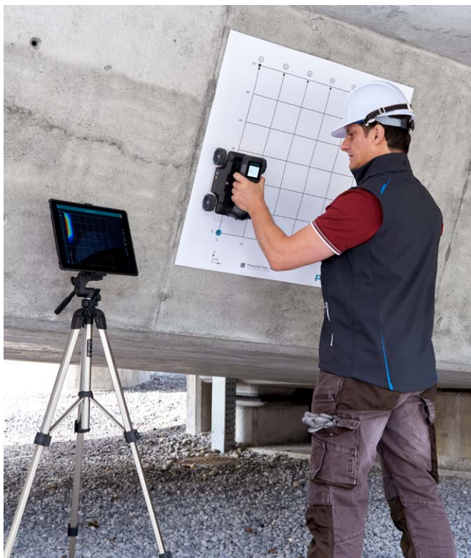
Proceq 격자 용지를 사용해서 영역 스캔을 수행하는 Proceq GPR Live
