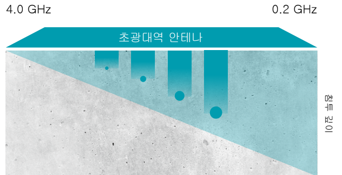
단일 장치로 0.2~4.0GHz의 모든 주파수 지원하는 Proceq GPR Live 주파수가 낮을 수록 더 깊이 침투하고 주파수가 높을 수록 더 작은 물체를 감지합니다.
