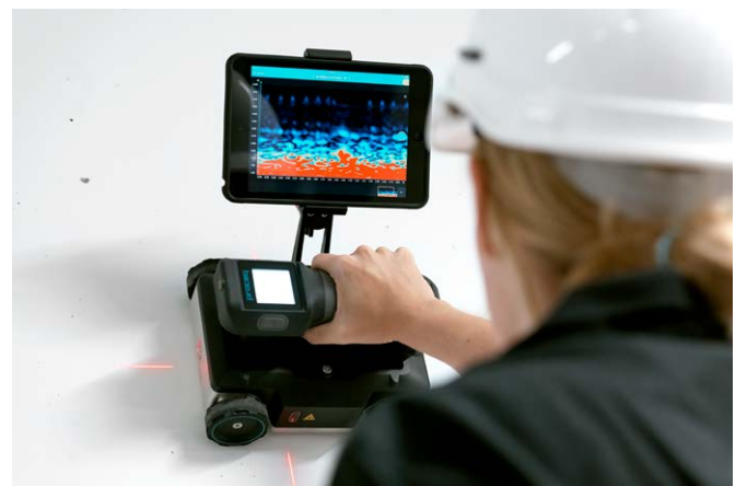
장치 태블릿 홀더와 결합된 Proceq GPR Live
